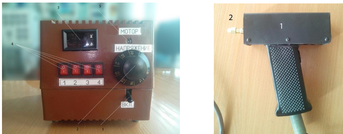
Рисунок 2. Конструктивные элементы разработанного электроискрового оборудования. а-блок питания прибора электроискрового легирования ЭИЛБ-1; б – Манипулятор вращающегося электрода
